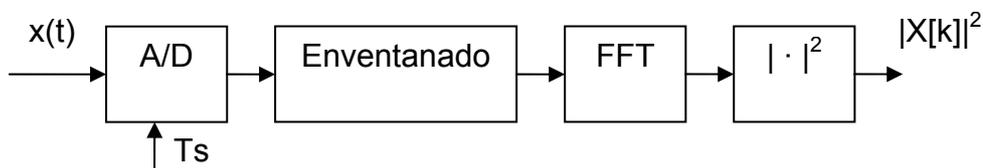
Suponiendo que el ancho de banda de la señal analógica es de 5 KHz, que la frecuencia de muestreo es de 10 KHz, que el número de puntos de la FFT coincide con la duración  $N$  del trozo de señal seleccionado, y que se desea una separación entre las muestras del espectro de 10 Hz:
