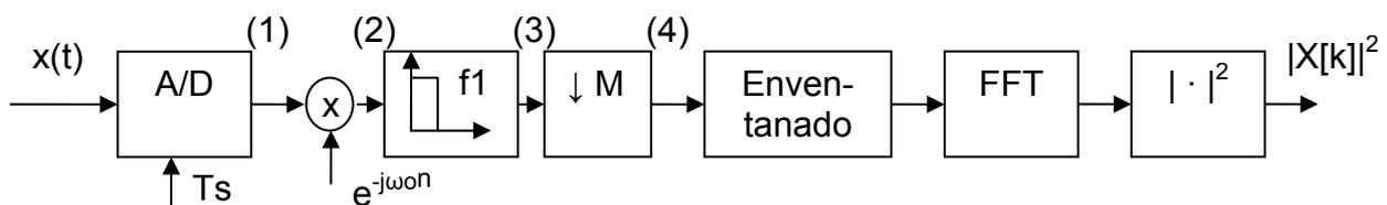
En esta figura se puede distinguir el producto por un fasor, un filtro paso bajo ideal de frecuencia de corte  $f_1$  y un diezmador por un factor de  $M$ .
