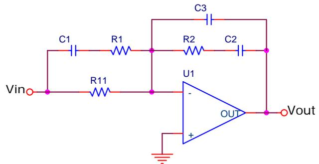
**Datos:**  $R_1=3K\Omega$ ;  $R_2=500K\Omega$ ;  $R_{11}=33K\Omega$ ;  $C_1=3nF$ ;
