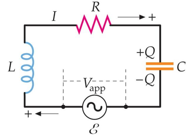
Un circuito serie LCR con  $L=2$  H,  $C=2$   $\mu\text{F}$ , y  $R=20$   $\Omega$  está conectado a un generador de frecuencia variable con un fem máxima de 100 V. Hallar la frecuencia de resonancia y la corriente máxima en resonancia.
