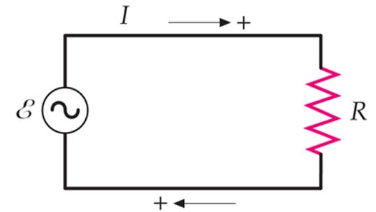
La potencia instantánea disipada en la resistencia viene dada por:
