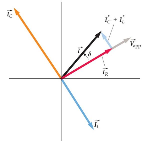
Los fasores correspondientes a las intensidades de corriente que atraviesan el condensador y la bobina,  $\vec{I}_C + \vec{I}_L$ , pueden sumarse fácilmente.
