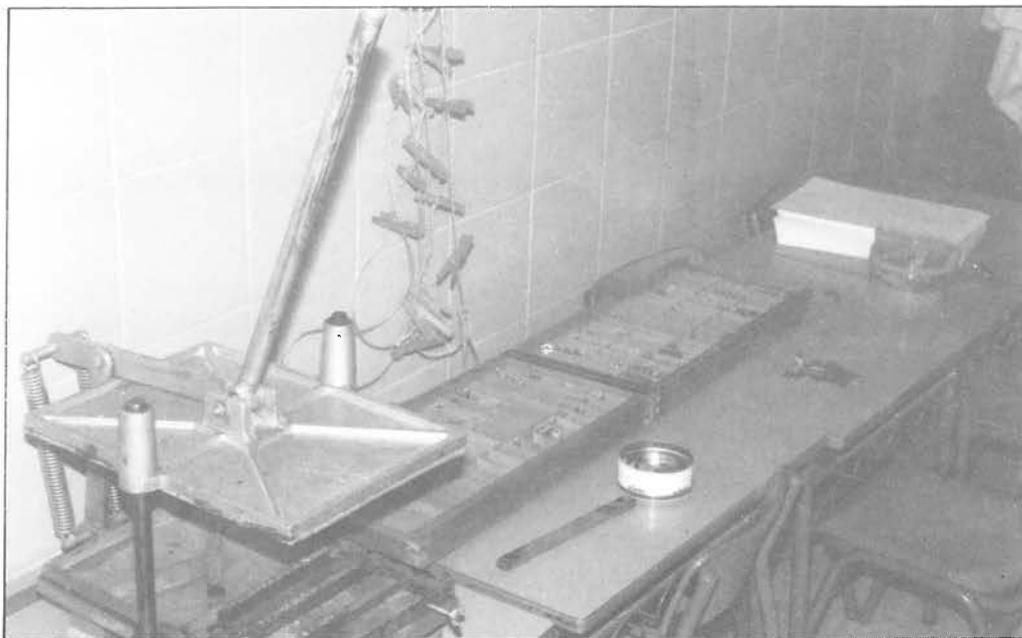
*Elementos que componen la imprenta de Plomo: Caja con los tipos clasificados, componedores y prensa.*
